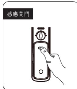
手柄上設計有感測器，在觸發紅外感應的情況下，手同時握住手柄的前、後觸摸感應模組即可解鎖。
